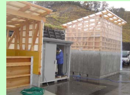
アンモニア回収後の残臭を地域未利用有機資材で脱臭
