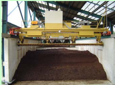
堆肥クレーンによる全自動天地返し 高頻度化で発酵促進
