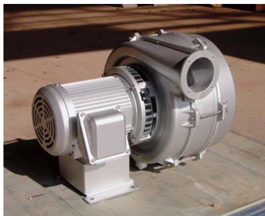
▼吸引通気用に選定したステンレス羽根のターボファン
