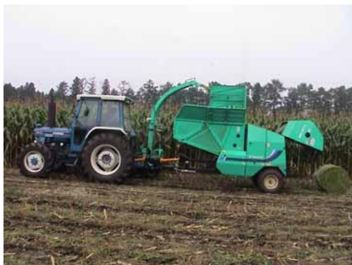
写真 1 細断型ロールベアラによる収穫作業
